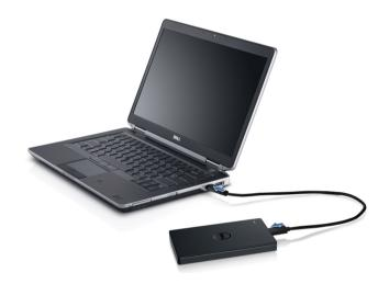
2 連接磁碟機後,此磁碟機將在連接並開啟磁碟機約 30 秒內,在(我的)電腦中以一個磁碟機代號(即磁碟機 E:、F: 或某些其他磁碟機代號)的形式顯示。
